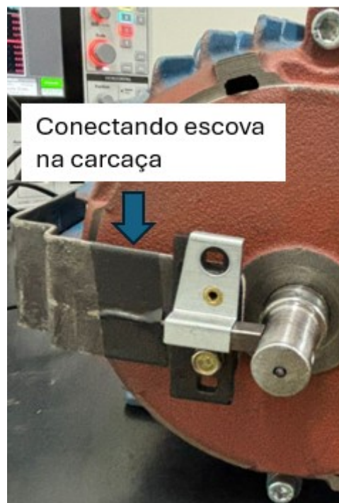
Figura 4.13: Alteração nas escovas, lado NDE, para realizar medição de V_{shaft} .
