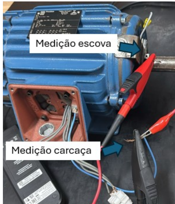
Figura 4.11: Medição das tensões no eixo lado DE.
