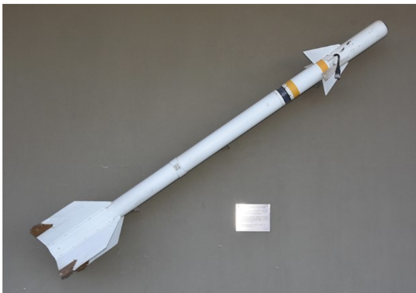
Figura 18- Míssil AIM-9 com guiagem infravermelha.
