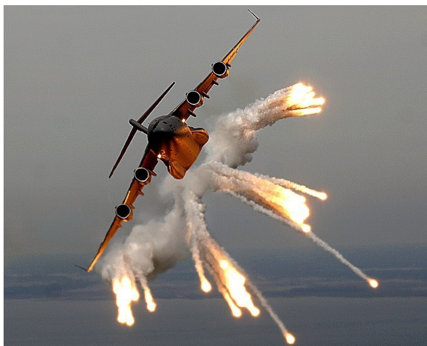
Figura 37: Dispositivo de contramedida Flare.
