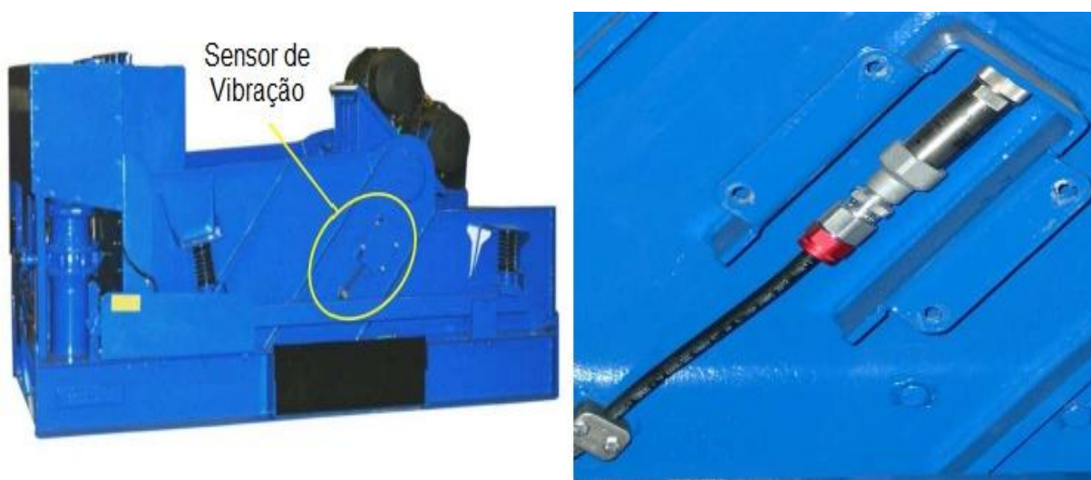
Figura 2.9 - Peneira vibratória equipada com o sensor de vibração.
