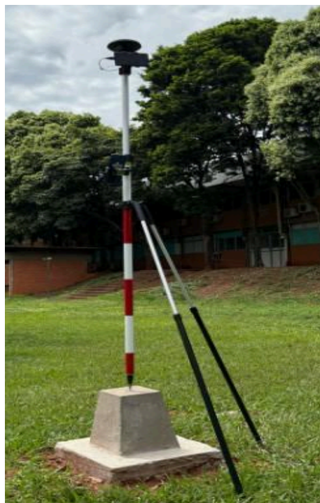
Figura 11: Captação de dados da rede geodésica com todos materiais - UFU
