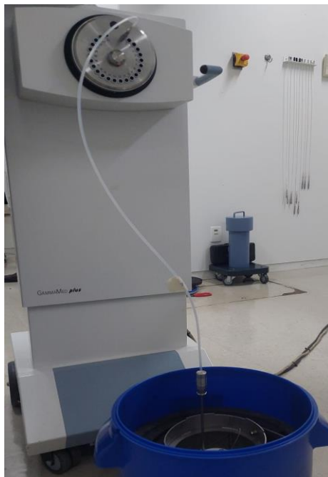
Figura 8: Procedimento de retirada da fonte de Ir-192. O GammaMed Plus é conectado ao container de transporte através do catéter, conforme mostrado na imagem, para realizar a troca da fonte do GammaMed Plus.
