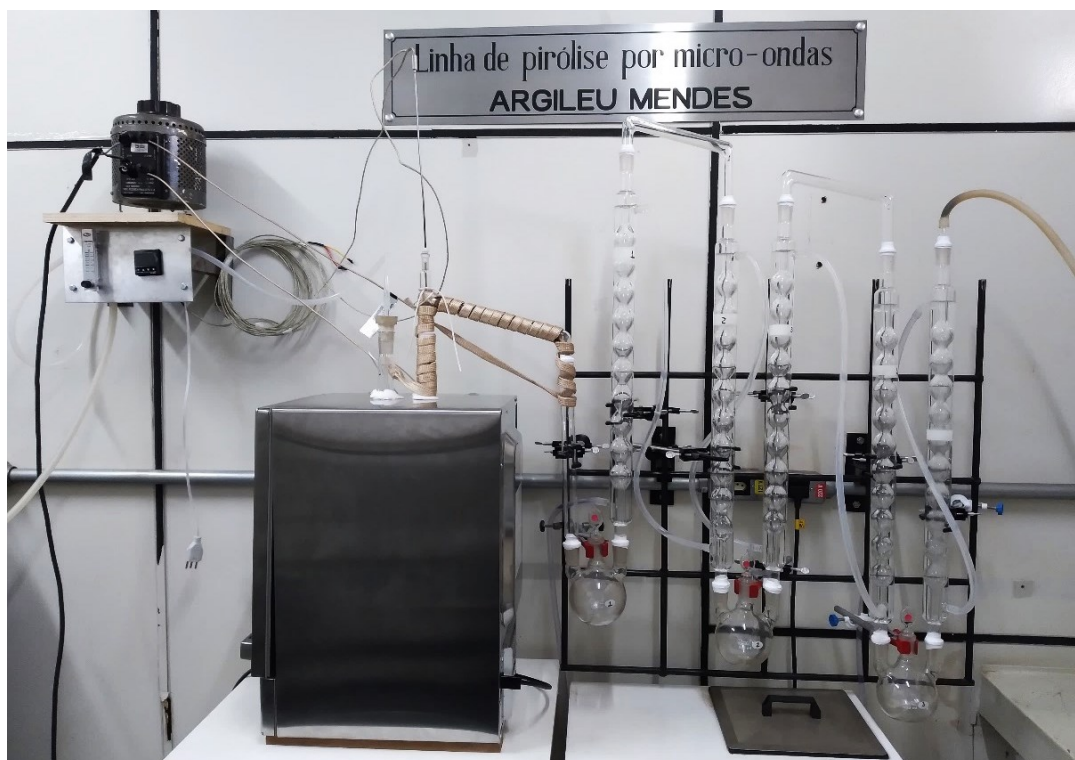
Figura 3.9 Linha de pirólise por micro-ondas “Argileu Mendes”.
