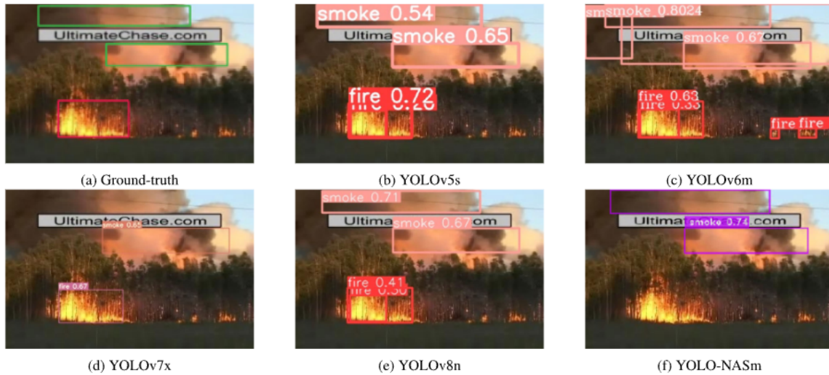
Figura 30 – Detecção de incêndios usando YOLO (CASAS et al., 2023).
