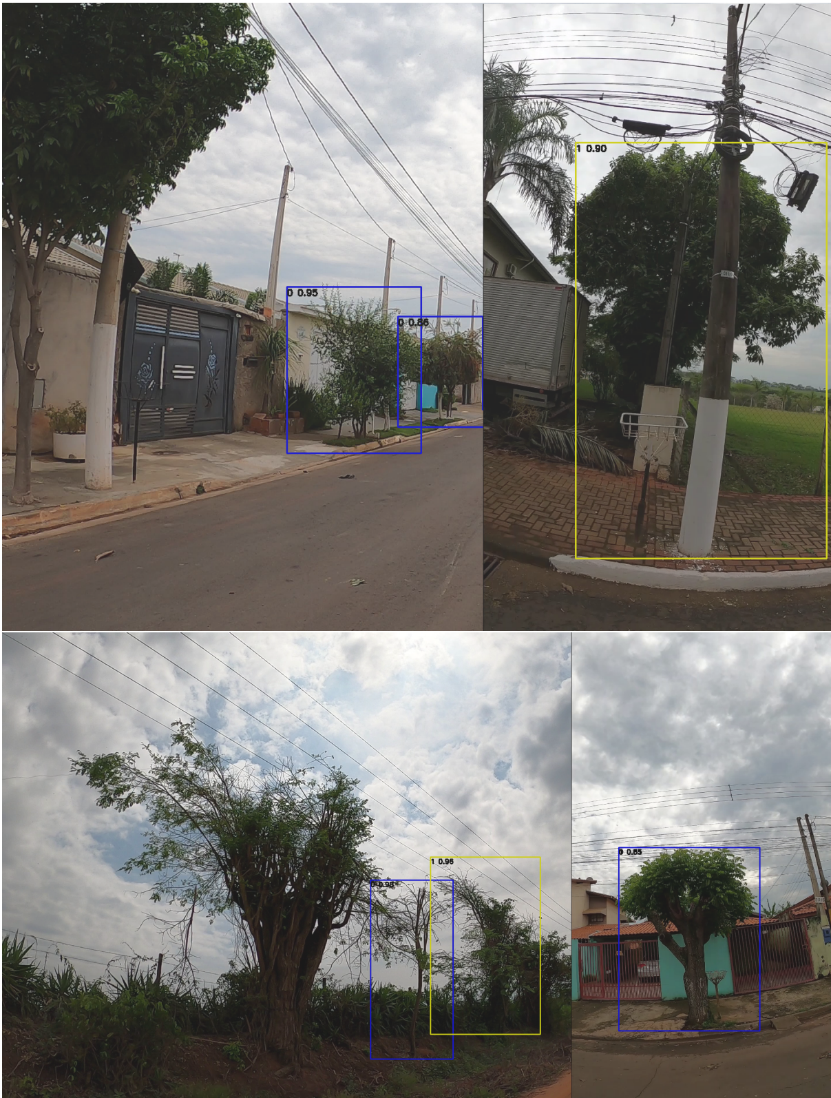
Figura 42 – Desafios de previsão do modelo: vegetação no final do quadro da imagem e árvores podadas que voltaram a crescer. Fonte: Elaborado pelo autor.
