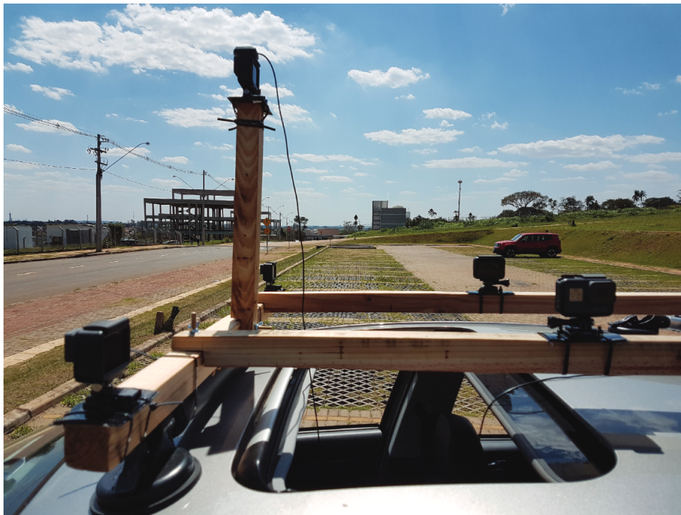
Figura 37 – Sistema de mapeamento móvel usado para a aquisição das imagens (MARQUES et al., 2021).
