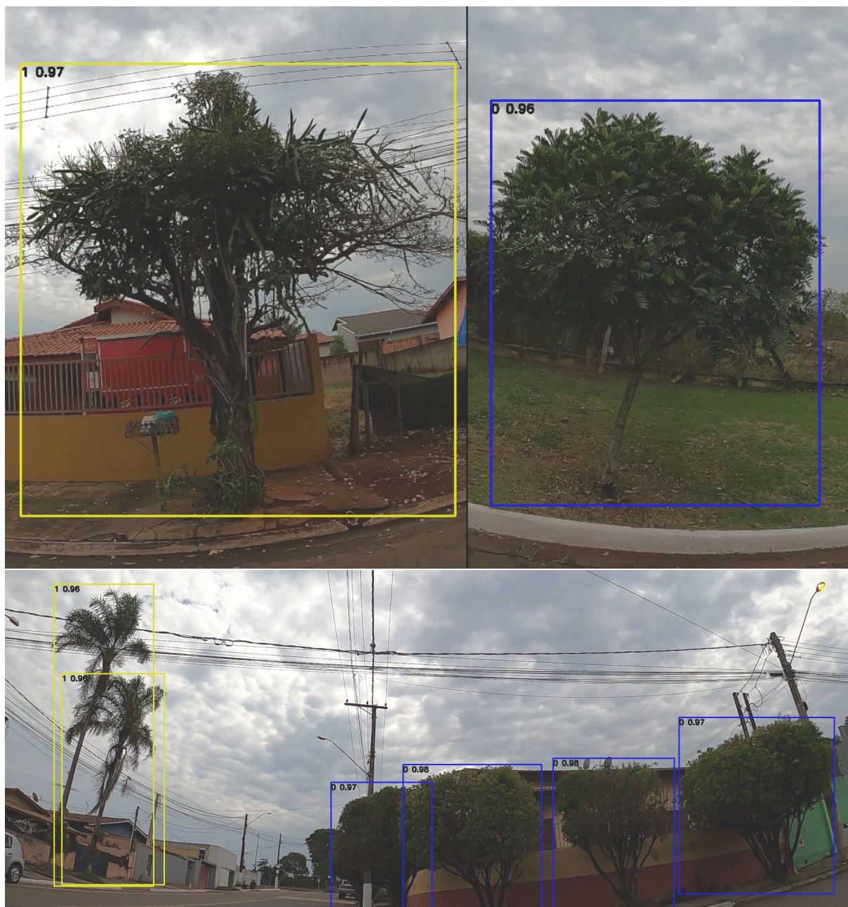
Figura 41 – Resultados da previsão da YOLOv10m, caixas amarelas correspondentes ao contato com LDE e caixas azuis correspondentes à ausência de contato. Fonte: Elaborado pelo autor.
