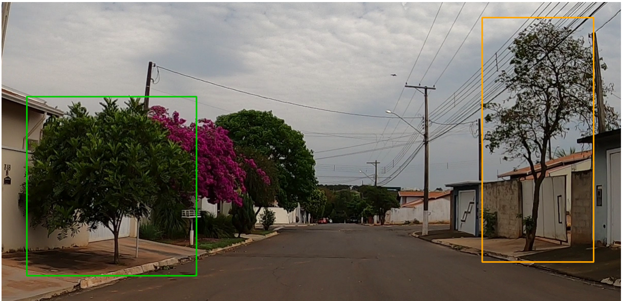
Figura 38 – Este é um exemplo de uma imagem rotulada (verdade fundamental), onde o quadrado verde à esquerda mostra uma árvore sem contato com a LDE, e o quadrado laranja à direita exibe uma árvore em contato com ela. Fonte: Elaborado pelo autor.
