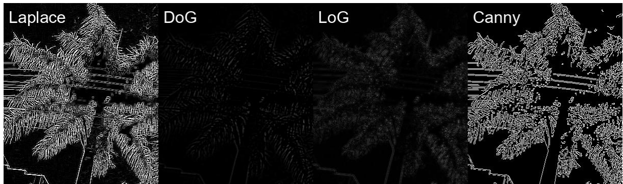
Figura 21 – Exemplo dos filtros de segunda ordem: Laplace, DoG, LoG e Canny. Fonte: Elaborado pelo autor.
