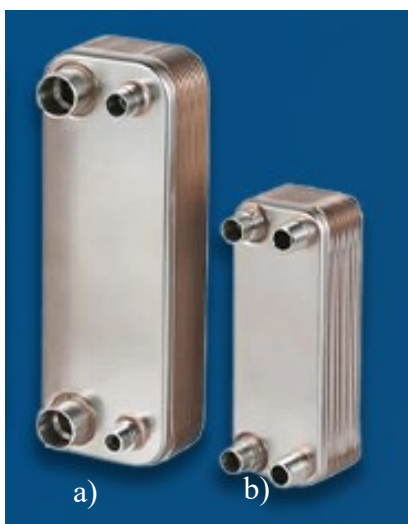
Figura 3.8 – Trocadores de placas brasados Brahex. a) Evaporador PHE P1S. b) Condensador PHE P0S. Fonte: www.brahex.com.br/brasados.html .
