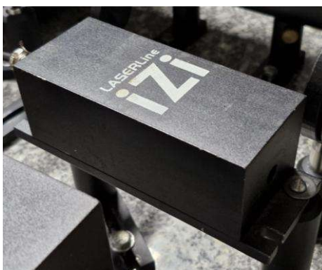
Figura 49: Fotografia do laser com comprimento de onda de excitação de 405 nm IZI da LaserLine na bancada do laboratório do GEM.
