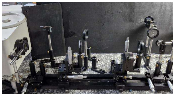
Figura 53: Fotografia da montagem experimental, na bancada do laboratório do GEM, que possibilita a realização de medidas de Fotoluminescência (PL), Elipsometria de Emissão (EE), macro Raman e Espectroscopia Raman por Elipsometria (ERS), com a inclusão dos elementos ópticos adequados e necessários para cada um dos casos.
