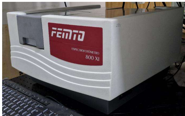
Figura 45: Fotografia do espectrofotômetro 800XI da FEMTO na bancada do laboratório do GEM.
