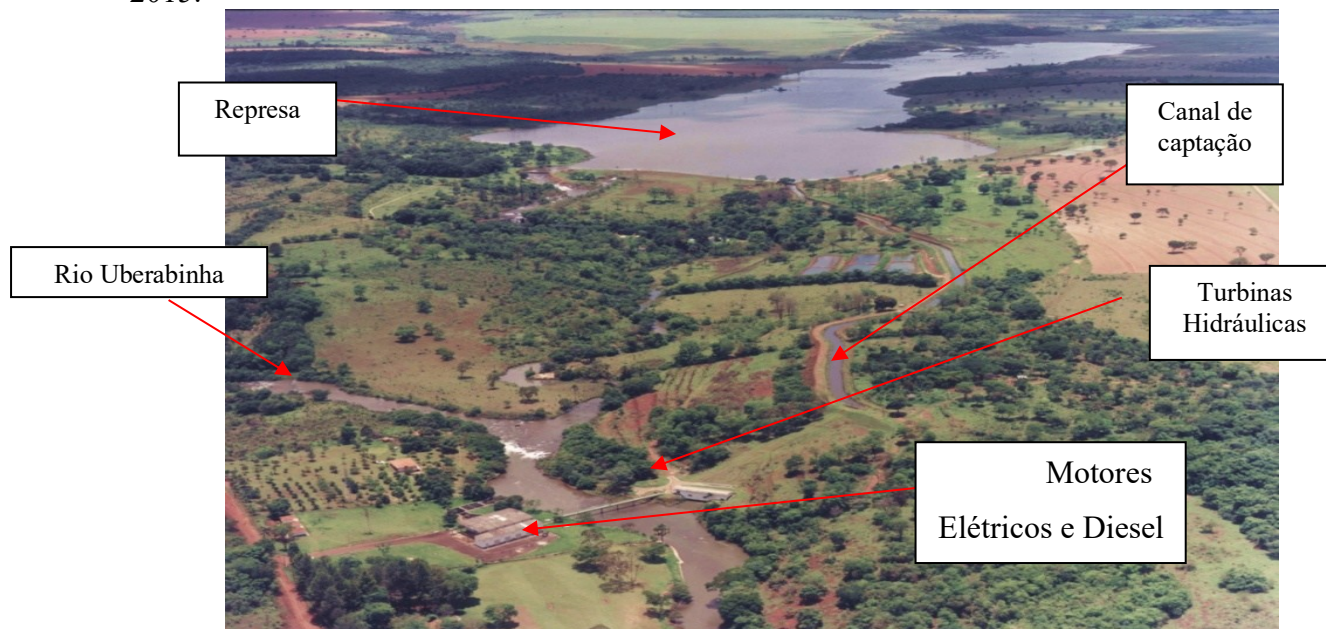
Figura 7. Uberlândia – MG: Visão panorâmica da área de captação no Ribeirão Bom Jardim, evidenciando a represa, o canal de derivação e a estrutura de condução até as casas de bombas, 2015.
