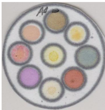
Figura 15 – Dispositivo analítico à base de papel com 9 spots para acomodação dos reagentes colorimétricos.
