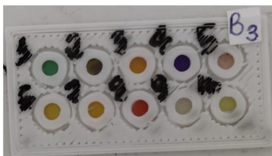
Figura 30 – Dispositivo analítico à base de amido com 10 spots para acomodação dos reagentes colorimétricos.
