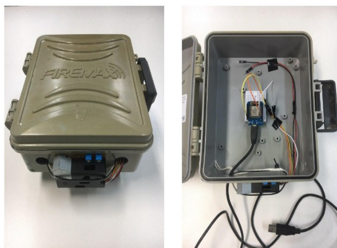
Figura 16 – Protótipo de estação de monitoramento integrada
