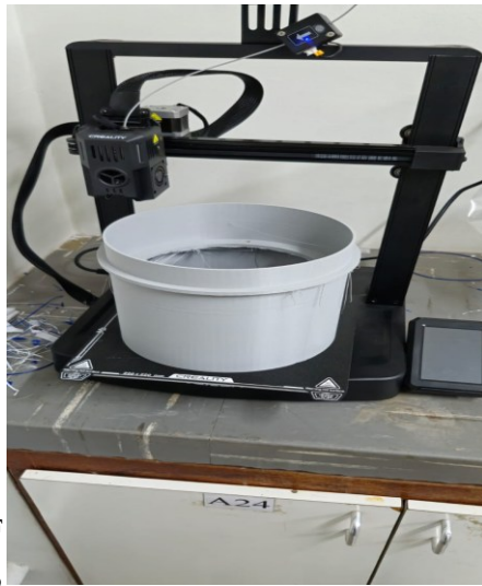
Figura 18 – Impressão do modelo em PLA
