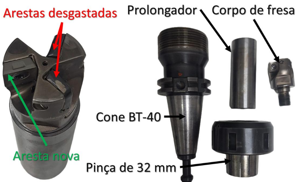
Figura 3.3 – Corpo de fresa G490.32.R.03-12 e ferramentas montadas
