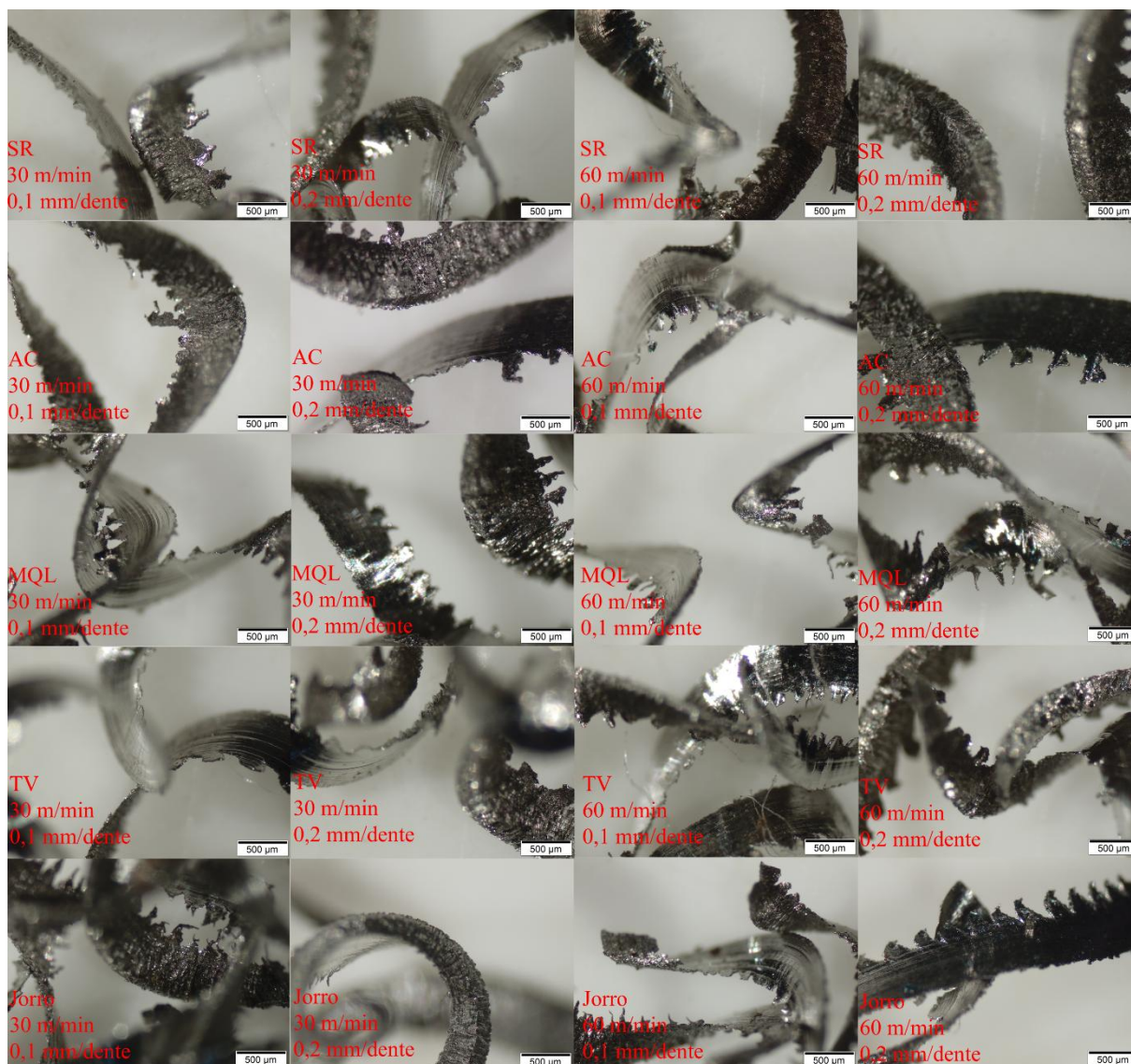
Figura 4.17 – Formato dos cavacos com ampliação de 4,5 vezes
