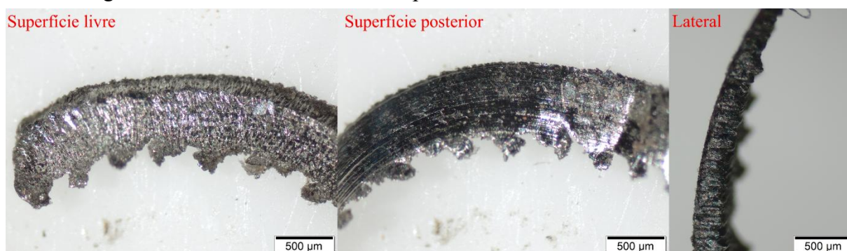
Figura 4.18 – Vistas de diferentes superfícies de um cavaco de Inconel® 718
