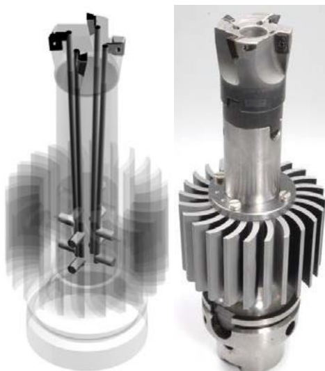
Figura 2.19 – Montagem dos tubos de calor na fresa, (Uhlmann et al. , 2017)
