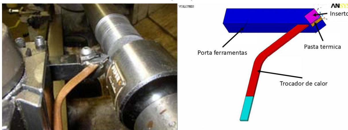
Figura 2.18 – Instalação do tubo de calor no porta-ferramentas, adaptado de Chiou et al. , (2003)
