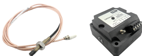
Figura 5.2: Conjunto para a aquisição das respostas de vibração do rotor.
