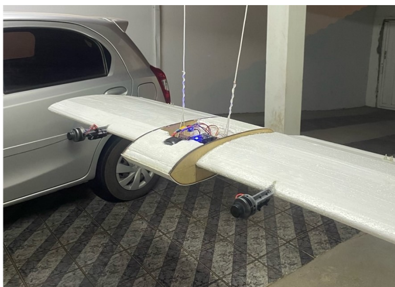
Figura 4.55 Protótipo com eletrônica montada. (Autoria própria).
