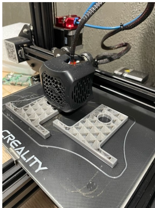
Figura 4.22 Suporte dos rolamentos da bancada de teste de tração, impressos em PETG. (Autoria própria)
