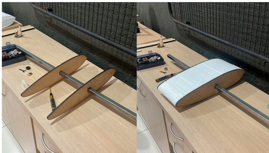
Figura 4.50 Disposição da longarina do protótipo. (Autoria própria)
