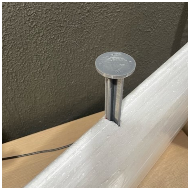
Figura 4.51 Base de fixação do motor. (Autoria própria)
