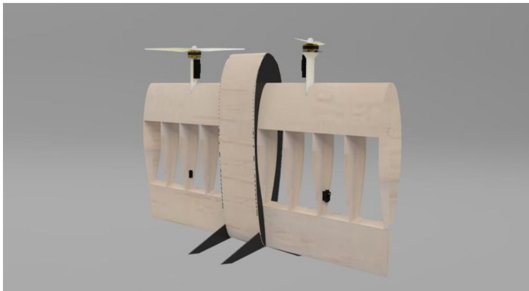
Figura 4.48 Representação visual da concepção inicial do trem de pouso. (Autoria própria)
