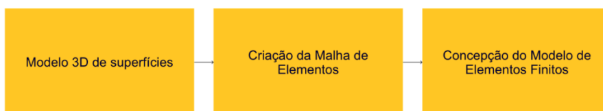
Figura 4.26 Fluxograma de modelagem estrutural de aeronave em modelo de elementos finitos. (Autoria própria)
