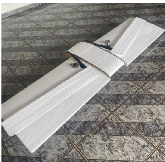
Figura 4.53 Base de isopor do protótipo da aeronave. (Autoria própria)
