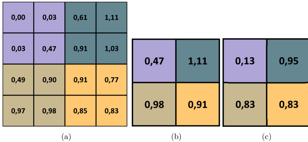
Figura 9 – Exemplos das operações max pooling (b) e average pooling (c) em uma matriz de tamanho 4×4 pixels (a), utilizando pool de tamanho 2×2 pixels (Figura extraída de (D. F. D. d. Santos 2022)).
