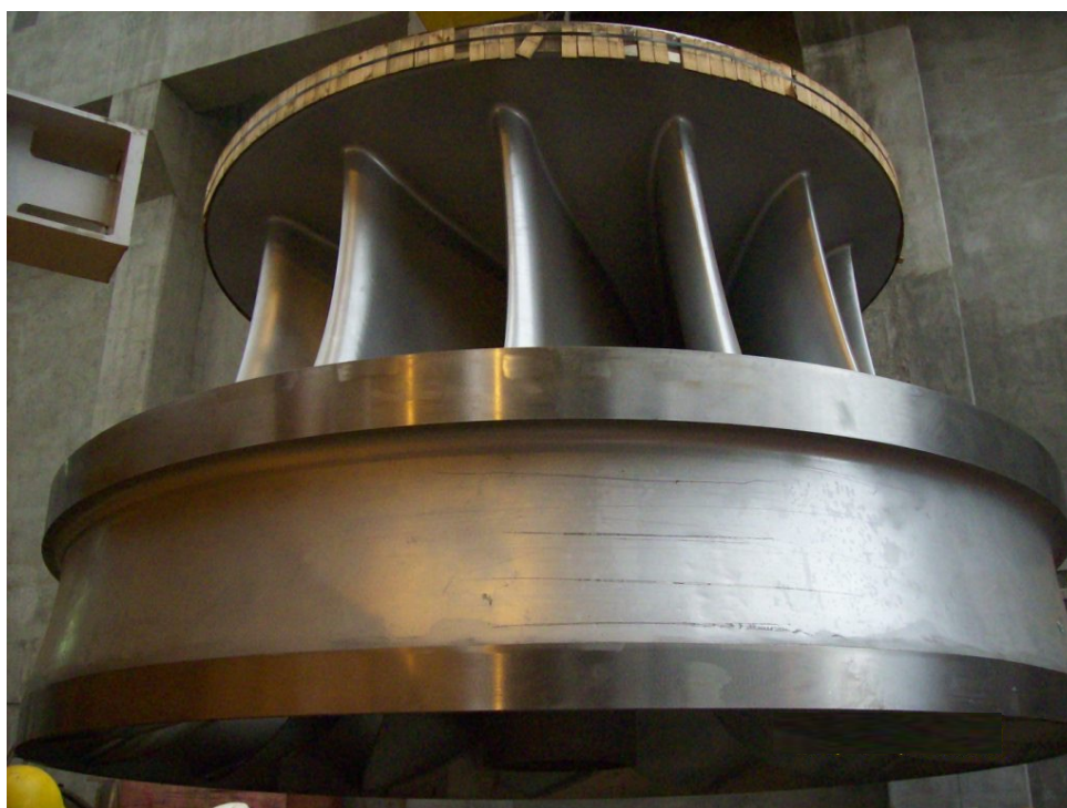
Figura 3.3: Turbina Francis da usina de Foz do Chapecó.
