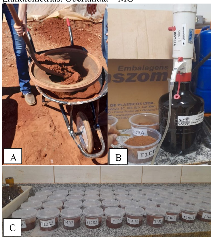
Figura 4 – Implantação do teste de incubação dos solos com diferentes corretivos de acidez e granulometrias. Uberlândia – MG
