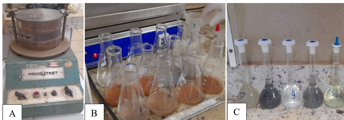
Figura 1 – Separação granulométrica e análise química dos corretivos
