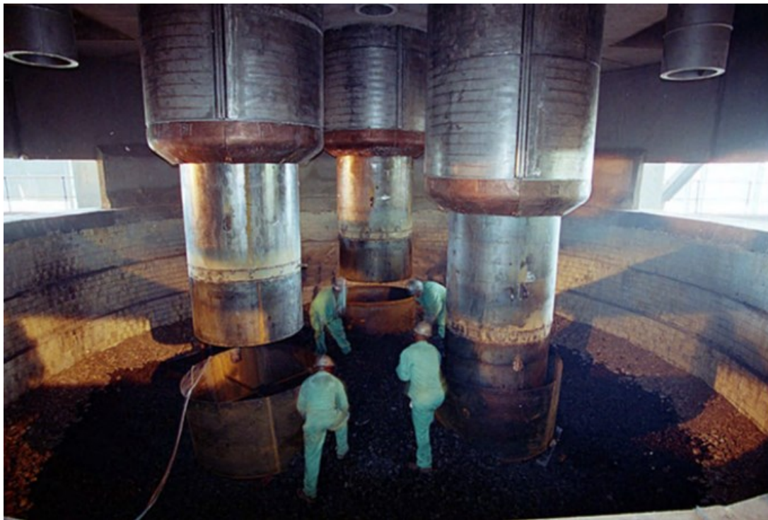
Figura 3.2.3- Forno circular com três eletrodos arranjados de forma triangular.
