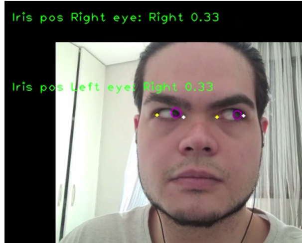
Figura 10 – Exemplo de localização da íris utilizando landmarks faciais para delimitar a ROI ocular e algoritmos de processamento de imagem para refinar a detecção do centro pupilar.
