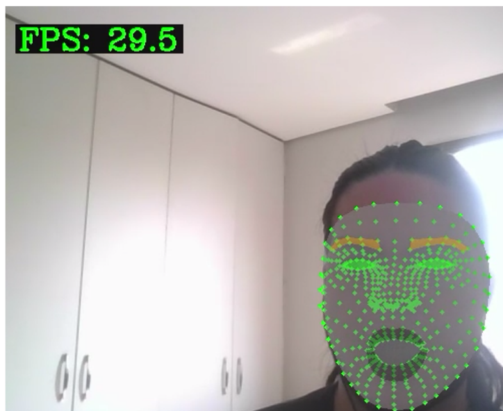
Figura 8 – Exemplo da malha de 468 pontos fiduciais faciais (Face Mesh) detectada pela biblioteca MediaPipe sobre uma face humana.
