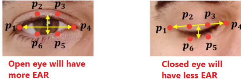
Figura 11 – Localização dos seis landmarks faciais ( P_1 a P_6 ) utilizados para o cálculo do Eye Aspect Ratio (EAR) para um olho.
