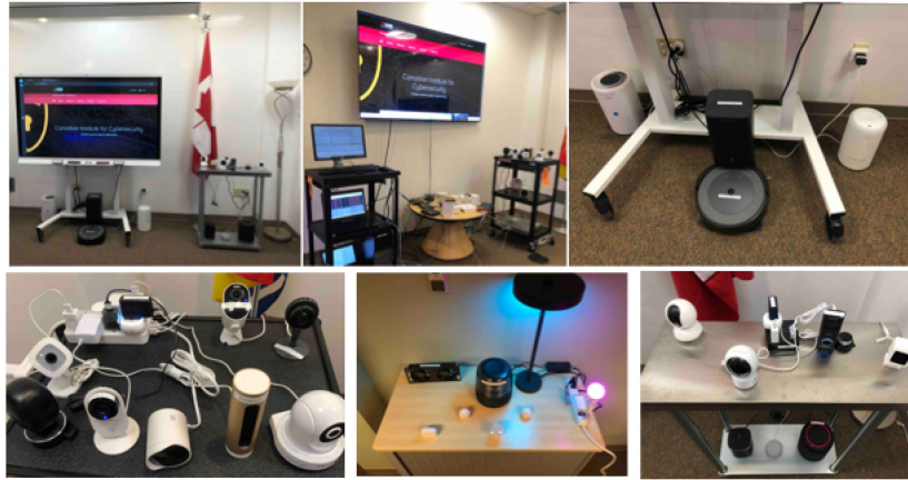
Figura 1 – Laboratório usado para a geração do dataset CICIoT2023, contendo diversos dispositivos IoT.
