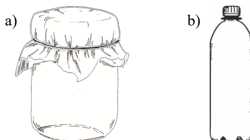
Figura 4.2 - Recipiente de vidro, para fermentação dos starters , e garrafa PET, para fermentação das bebidas, reatores 1 (a) e 2 (b), respectivamente.
