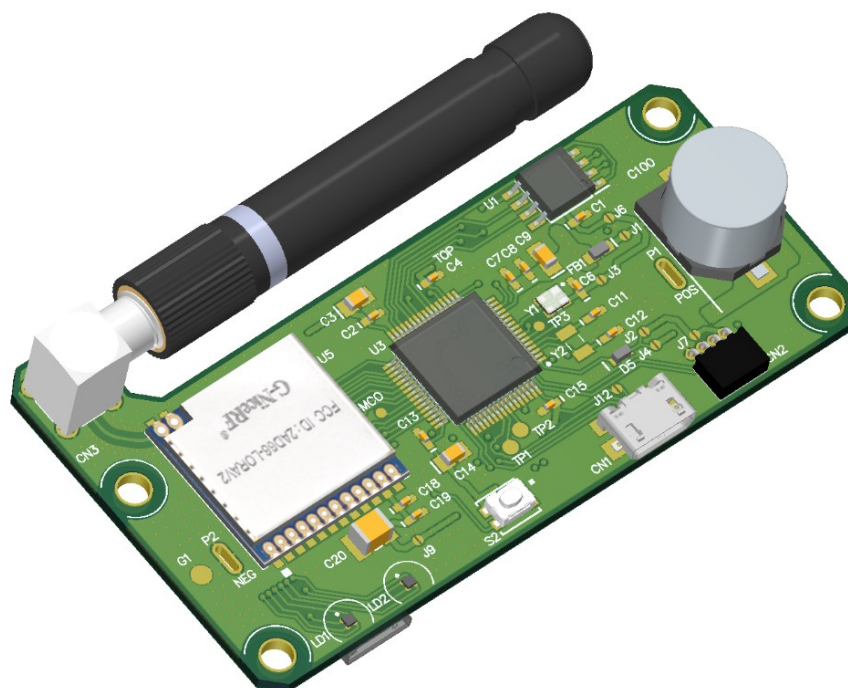
Figura 19 - Representação tridimensional da PCI com componentes eletrônicos do ED LoRaWAN desenvolvido
