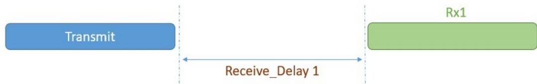
Figura 12 - Visão simplificada do modo de operação de um ED classe A no LoRaWAN quando a rede (GW, NS e AS) responde de volta na janela RX1.
