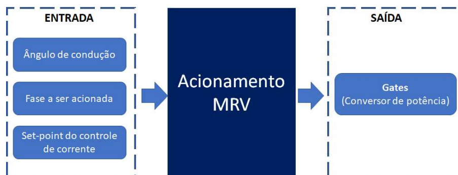
Figura 78 – Diagrama de blocos simplificado da estratégia de acionamento da MRV.
