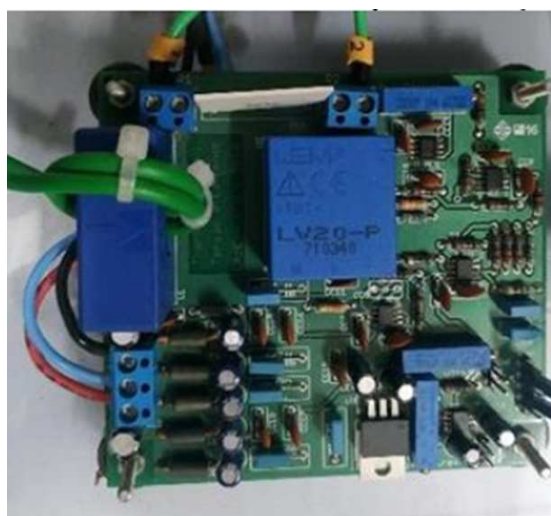
Figura 77 – Placa condicionadora de sinais para medição de corrente e tensão.
