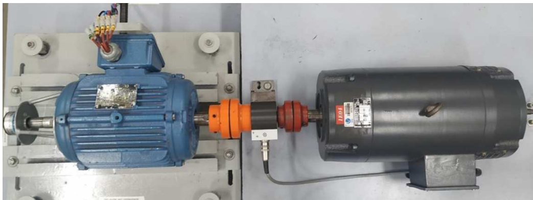
Figura 74 – Máquina a Relutância Variável acoplada do Motor/Gerador de Corrente Contínua.
