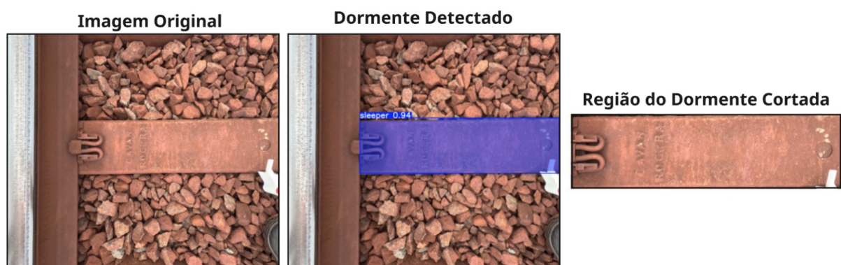
Figura 13 – Exemplo de detecção do dormente em uma das imagens. A saída é uma imagem de dimensão reduzida, apenas com a região de interesse.
