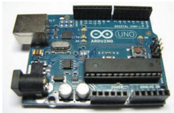
Figura 2 – Placa Arduino UNO utilizada no trabalho, (MCROBERTS, 2011).
