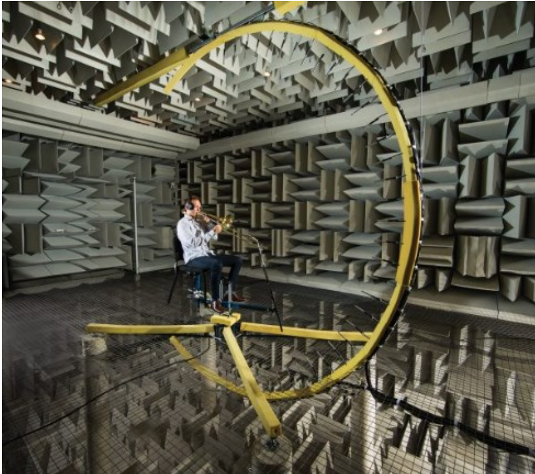
Figura 3.2 - Um estudante sentado em uma cadeira suspensa na câmara anecoica. Fonte: Adaptado de PHILBRICK, Mark A. "The quietest place to study". Y MAGAZINE, Out of the Blue (2015). Disponível em: https://magazine.byu.edu/article/the-quietest-place-to-study/ .
