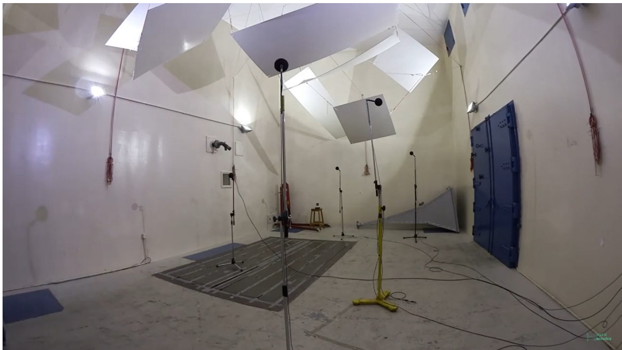
Figura 3.3 - Imagem do vídeo "Ensaio de absorção sonora da lã de rocha". O vídeo mostra a análise de absorção sonora utilizando lã de rocha. Fonte: SERRANO, Pablo. Ensaio de absorção sonora da lã de rocha. YouTube, 2018. Disponível em: https://www.youtube.com/watch?v=uPVNS9YU0ys .
