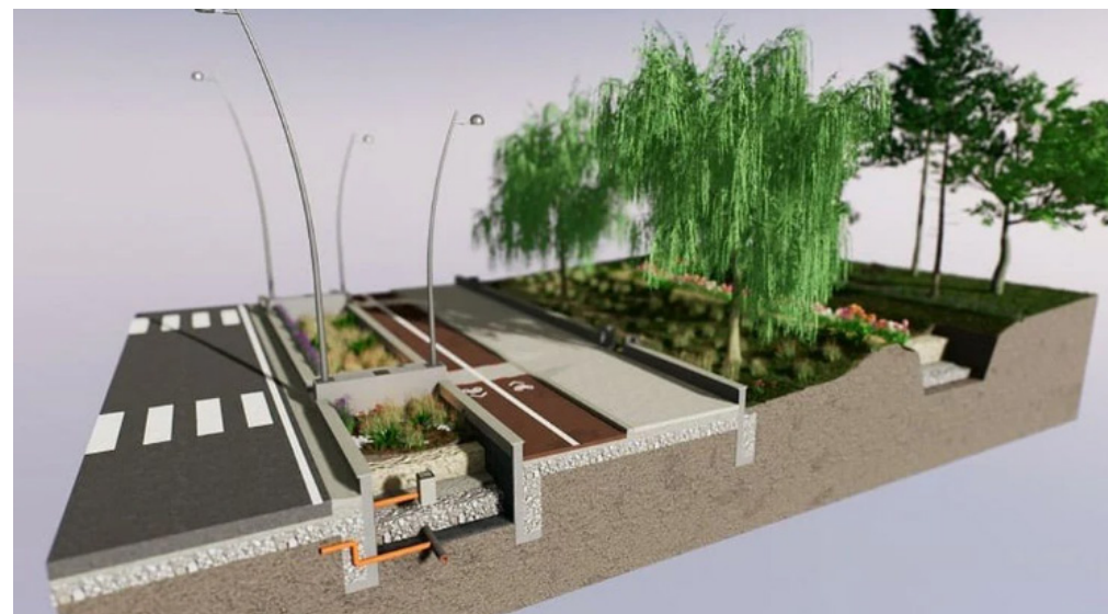
Figura 31: Corte esquemático de sistema de drenagem urbana sustentável, com jardins de chuva.
