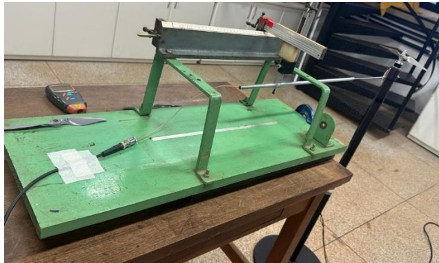
Figura 24 – Suporte utilizado para a sonda do anemômetro.
