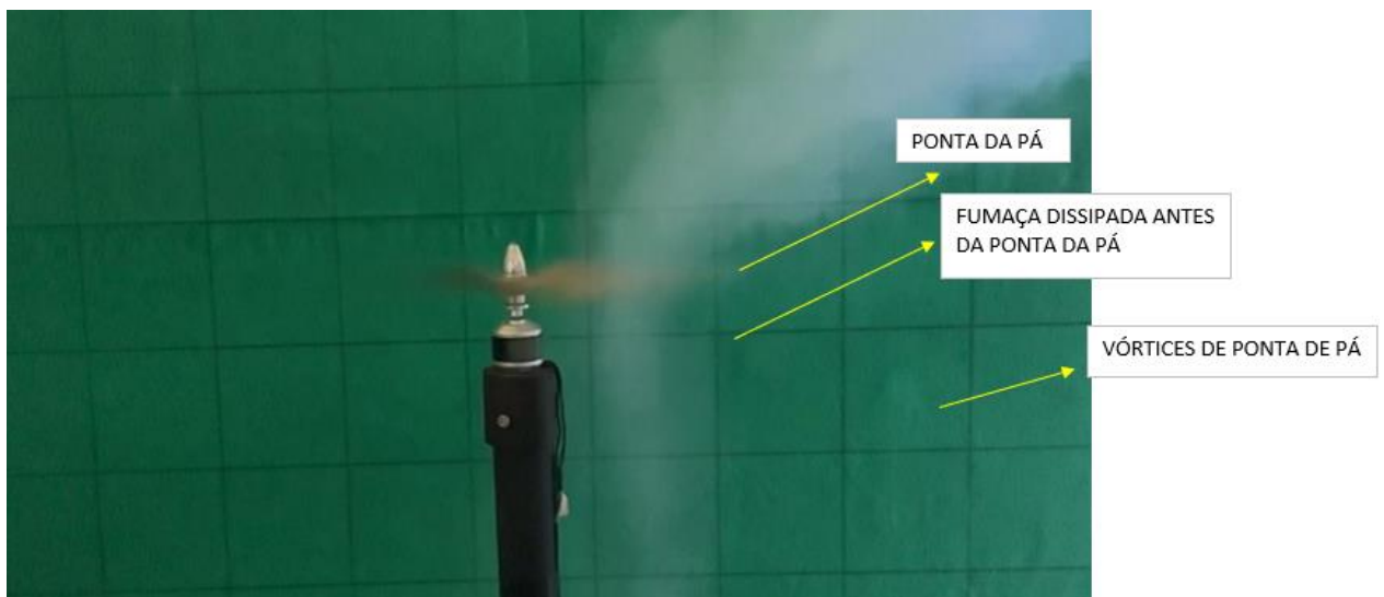
Figura 43 – Vórtices de ponta de pá.
