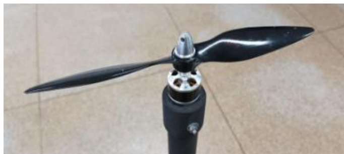
Figura 23 – Hélice APC 9x6E e motor acoplado na peça feita por impressão 3D.
