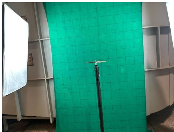
Figura 32 – Montagem da sessão de visualização com fio de fumaça.
