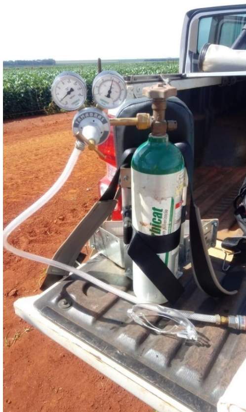
Figura 3 - Pulverizador costal com pressão constante
