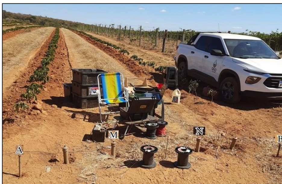
Figura 5: Disposição do arranjo com os eletrodos de injeção de corrente (A e B) e os eletrodos não polarizados (M e N).
