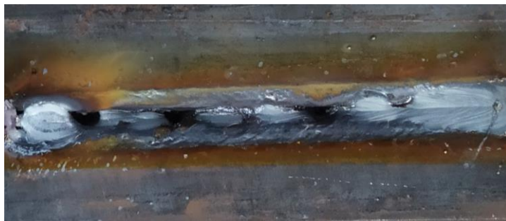
Figura 3.6 – Vista de baixo da junta, mostrando perfurações ao longo do cordão devido ao excesso de velocidade de soldagem
