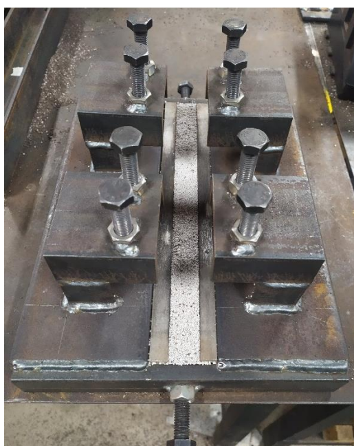
Figura 3.4 – Suporte de fixação das chapas para os experimentos com o fluxo disposto sobre o rasgo para acomodação
