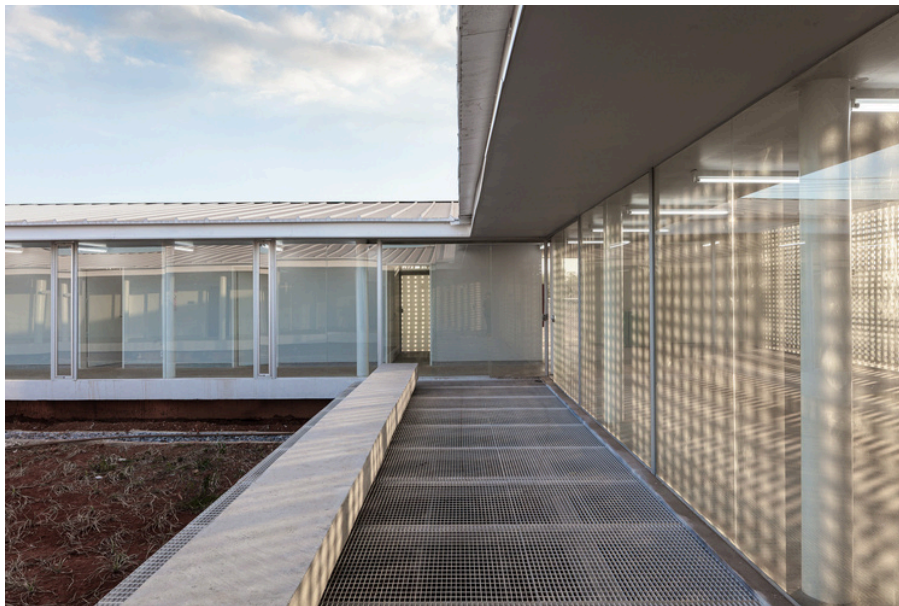
Cobertura leve, lajes de concreto armado e pilares metálicos.
