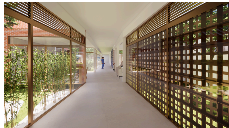
Figura 88 - Corredor do eixo linear estruturante com destaque para as esquadrias em vidro com veneziana e cobogó na fachada crítica. Elaborado pela autora.
