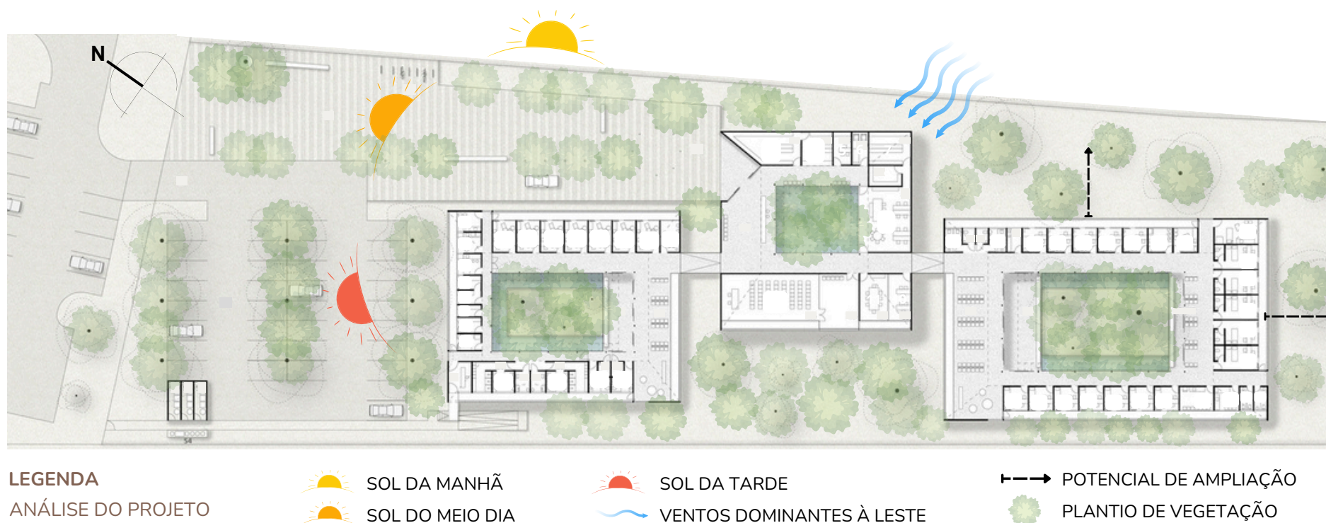
Figura 54 - Implantação da UBS Parque do Riacho: análise das condicionantes climáticas e indicações de alterações projetuais. Fonte: Saboia+Ruiz Arquitetos. Adaptado pela autora.
