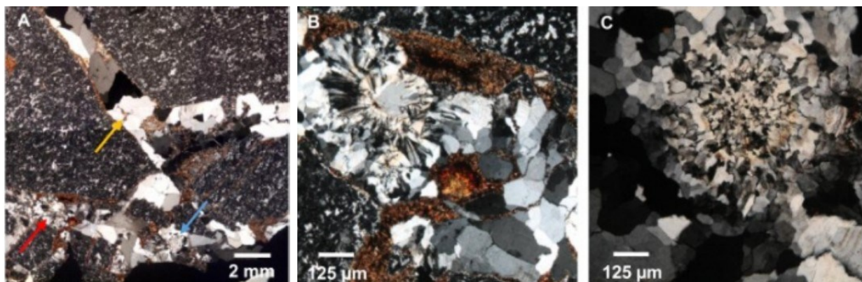
Figura 2 - Exemplos de fases minerais de sílica em silcrete proveniente do Vale do Rio Nahe, Alemanha. (A) Porosidade completamente preenchida por quartzo macrocristalino (seta amarela), calcedônia (seta vermelha) e quartzo microcristalino não-fibroso (seta azul). (B) Detalhe da calcedônia fibro-radial (seta vermelha em A). (C) Detalhe de zona com quartzo microcristalino não-fibroso.
