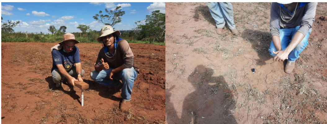
Figura 3. Equipamento PR2 Prolife Probe (tubo) e HH2 Moisture Meter (controle).
