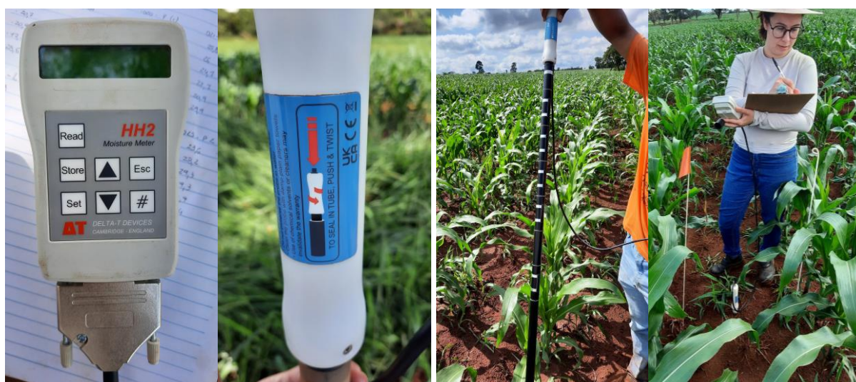
Figura 3. Equipamento PR2 Prolife Probe (tubo) e HH2 Moisture Meter (controle).
