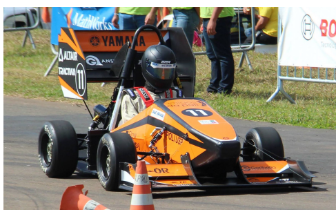
(a) Utilização de perfil arqueado nas asas dianteira e traseira de um carro de competição na Formula SAE.
