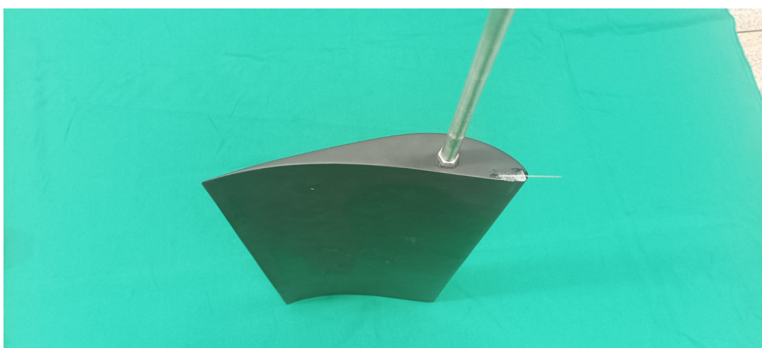
Figura 21 – Perfil E95 impresso com a haste da balança aerodinâmica fixada.
