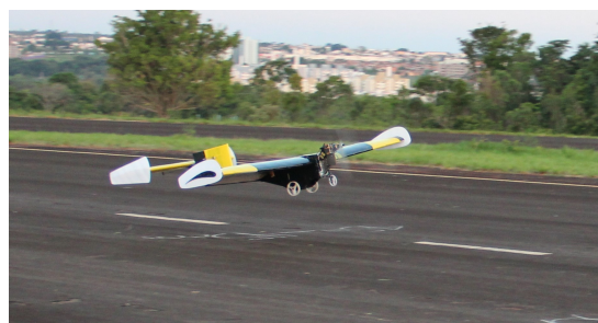
(b) Utilização de perfil arqueado na asa principal de uma aeronave de competição da SAE aerodesign.
