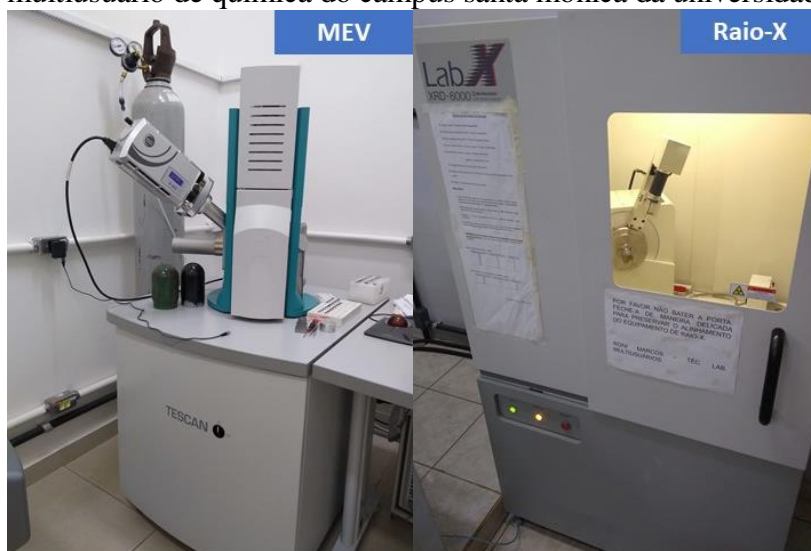
Figura 37 – Microscópio eletrônico de varredura (MEV) e Shimadzu XRD-6000 do laboratório multiusuário de química do campus santa mônica da universidade federal de uberlândia
