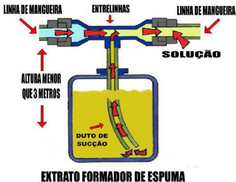
Figura 2 – Tubo venturi conectado a um reservatório de LGE.
