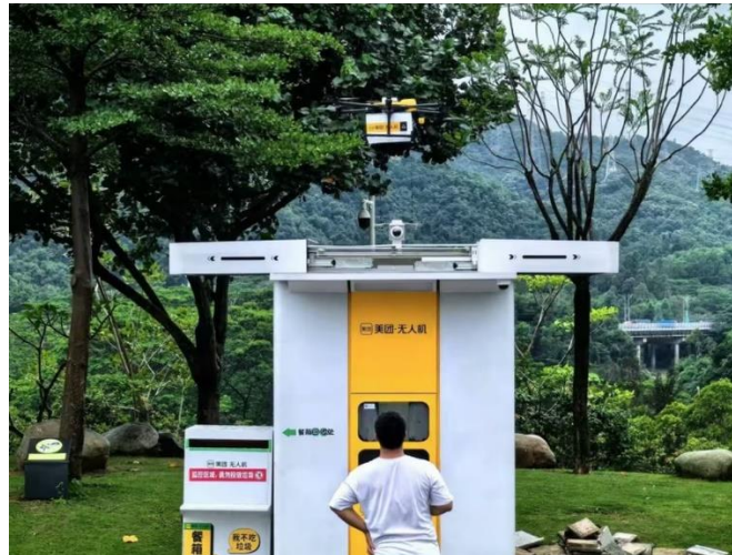
Imagem 4: Cabine para depósito de encomenda entregue por drone
