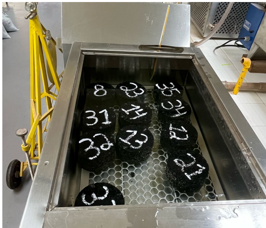
Figura 5 – Condicionamento dos CP's em banho-maria na temperatura de 50°C.
