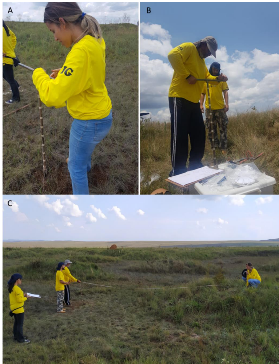
Figura 38: (A/B) Coleta com uso de trado holandês (C) Medição de alturas e diâmetros dos murundus
