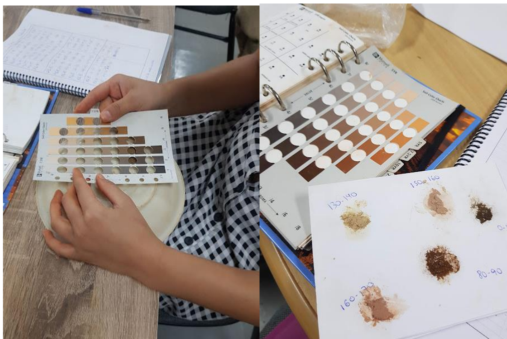
Figura 39: Procedimento para se obter a coloração do solo através da carta de Munsell. Observação: Nesta análise é importante umidificar o solo caso ele esteja seco para melhor visualização da cor.
