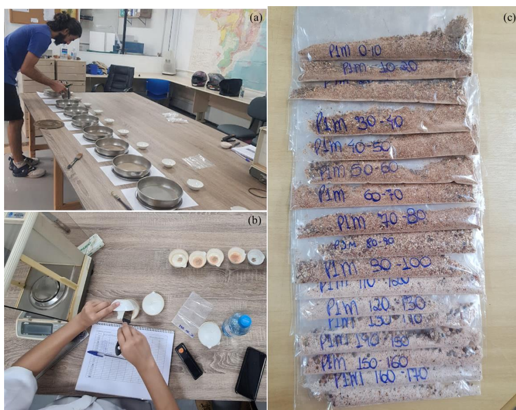
Figura 43: (a) Separação das amostras por cada peneira, antes de pesar é necessário tirar todos os materiais que ficaram presos na peneira e transpor para as cápsulas de porcelana para posterior pesagem (b).
