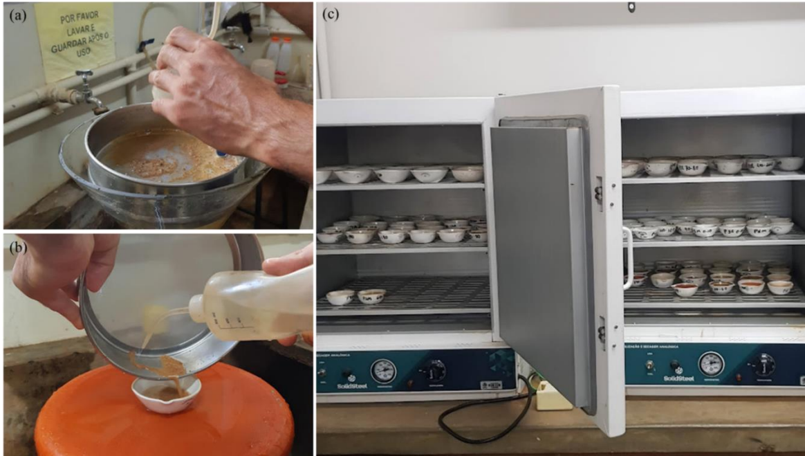
Figura 45: (a) Procedimento de lavagem da amostra separando a areia que fica retida na peneira da argila e silte (b) Destinação do material (areia) retido para as cápsulas de porcelana, para em seguida ir para a estufa (c).
