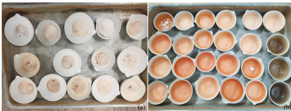
Figura 47: Disposição das cápsulas de porcelana após secagem na estufa (a) cápsulas com areia (b) cápsulas com argila.
