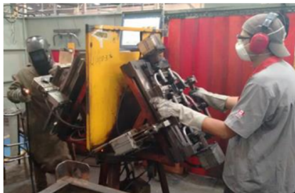
Figura 18 – Soldador e Montador na Aplicação Manual
