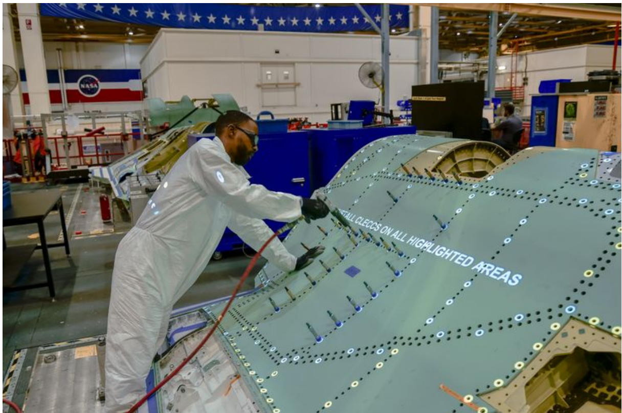
Figura 1 – Foto do processo de rebiteagem de componentes estruturais em um caça Lockheed Martin F-35 Lightning II (WALDRON, 2019).
