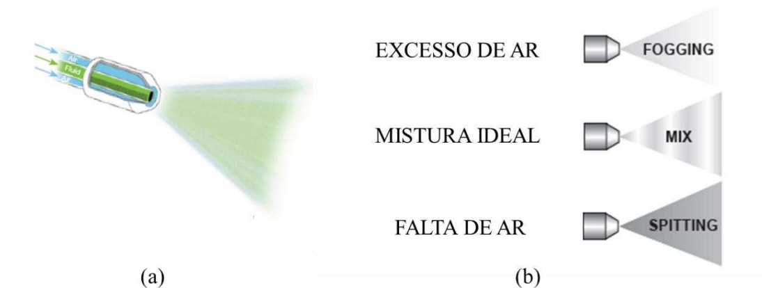
Figura 38 - Aplicação da mistura ar com fluido de corte, (a) sistema de mistura e (b) três tipos possíveis de aplicação da mistura.
