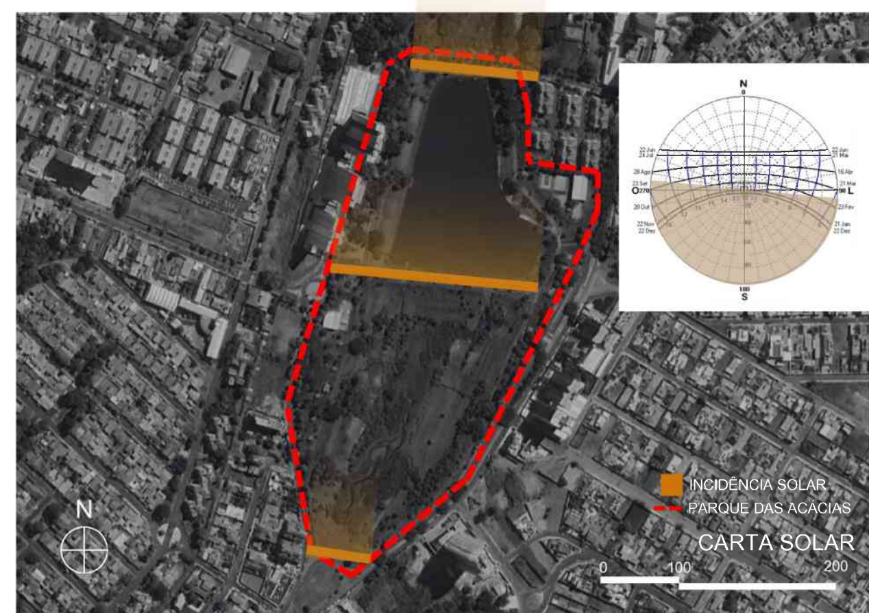
Mapa 17 - Estudos de incidência solar na Fachada Norte. Fonte: Elaborado pela Autora.
