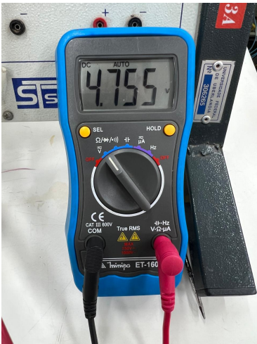
Figura 39 – Leitura da saída do sensor de posição pelo multímetro.
