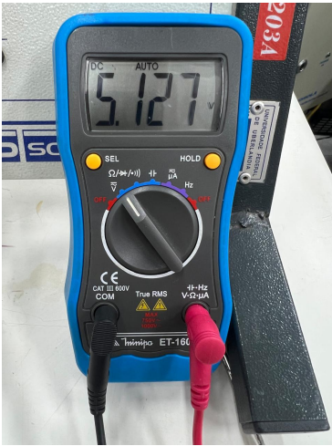
Figura 43 – Leitura da entrada da válvula pelo multímetro.
