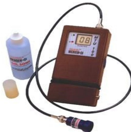
Figura 2: Medidor de espessura de toucinho, modelo MTU-100, fabricado pela empresa Microem®.
