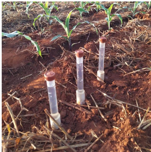
Figura 4: Bateria de tensiômetros em diferentes profundidades.
