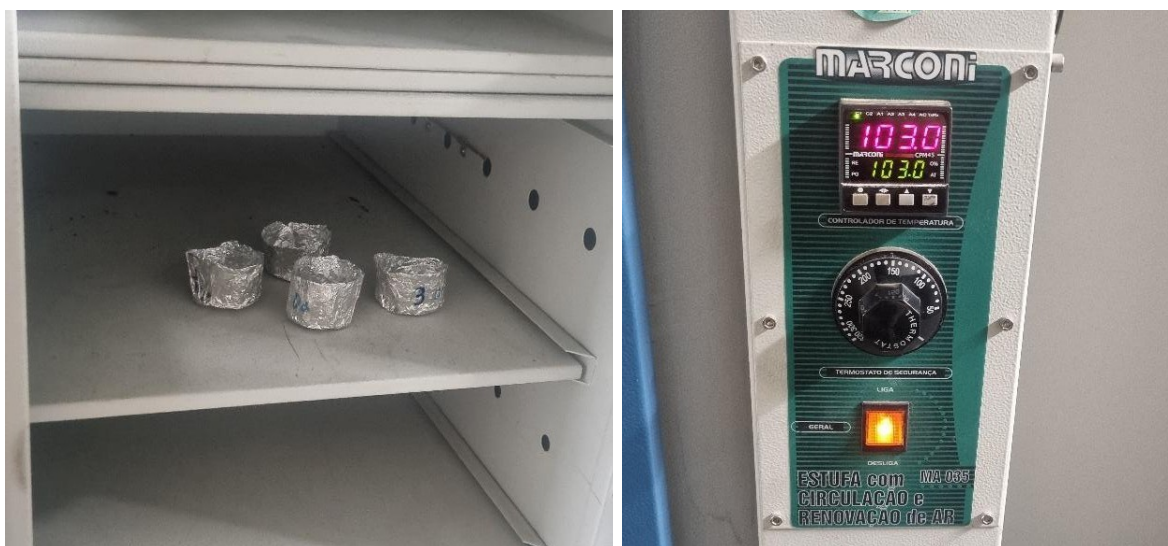
Figura 1. Copos de alumínio com sementes, já dentro da estufa (esquerda). Estufa ligada a 103°C (direita).
