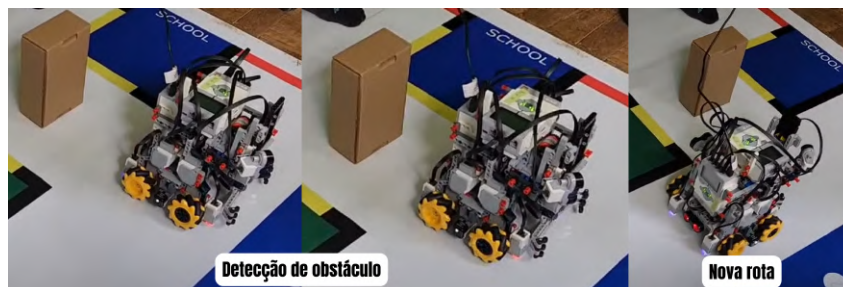
Figura 39 – Exemplo de detecção de obstáculo e recálculo de rota com sucesso, já no início do desenvolvimento do robô. Fonte: Arquivo Pessoal.
