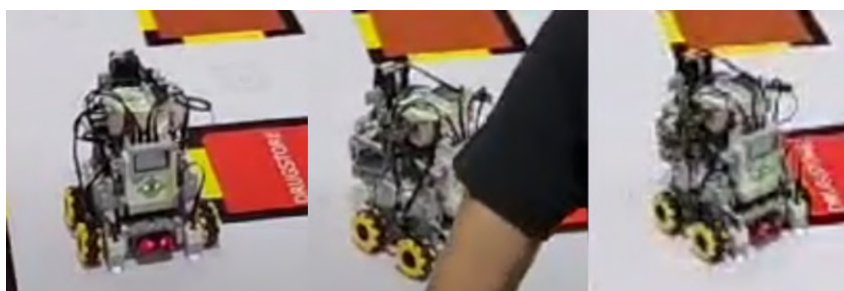
Figura 38 – Exemplo de erro no alinhamento lateral do seguidor de caminho em uma partida na competição. Fonte: Arquivo Pessoal.
