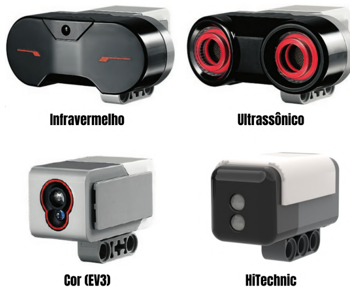
Figura 9 – Sensores infravermelho, ultrassônico, de cor e HiTechnic .
